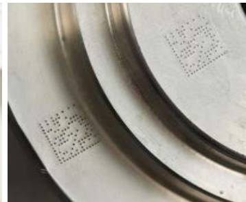
Marquage sur plan incliné, surface déformée, planéité inégale
